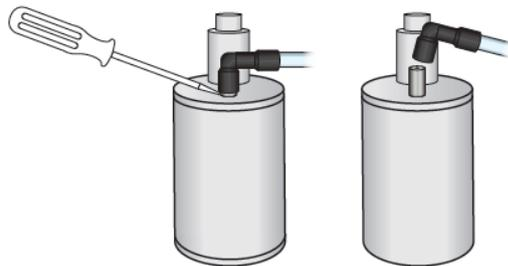
1. Enlever prudemment le tube d'aération avec un tournevis et enlever le tube du boîtier.
